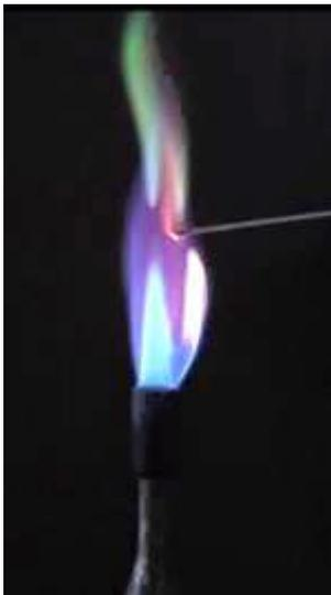
Regt man bestimmte Verbindungen mit Energie (z. B. Wärmeenergie) an, können Radikale entstehen, deren *äußere* Elektronen ein höheres Energieniveau haben. Um wieder auf ein niedrigeres Niveau zu gelangen, müssen sie die überschüssige Energie wieder abgeben. Das geschieht in Form von Licht unterschiedlicher Wellenlängen. Die Wellenlänge ist für das jeweilige Element charakteristisch.
