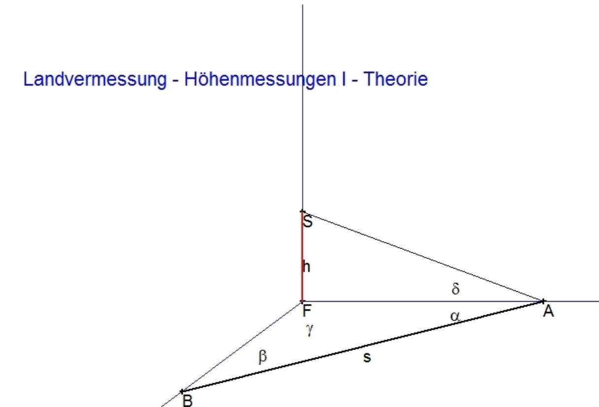
Auf der Ebene steht ein lotrechter Turm mit unzugänglichem Fußpunkt  $F$  und unbekannter Höhe  $h = FS$ . Um diese Höhe zu ermitteln, werden in der Ebene die Standlinie  $s = AB$  und die Winkel  $a = w(BAF)$  und  $b = w(ABF)$  gemessen. Vom Punkt  $A$  wird zur Turmspitze  $S$  der Höhenwinkel  $d = w(FAS)$  bestimmt. Aus diesen Daten kann die Höhe  $h = FS$  berechnet werden.
