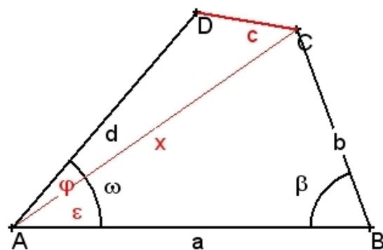
Von einem viereckigen Grundstück ABCD werden die Seiten  $a = AB$ ,  $b = BC$  und  $d = AD$  gemessen. Außerdem werden auch die zwei Winkel  $\omega = w(\text{BAD})$  und  $\beta = w(\text{ABC})$  bestimmt. Damit soll die unbekannte Seite  $c = DC$  ermittelt werden.
