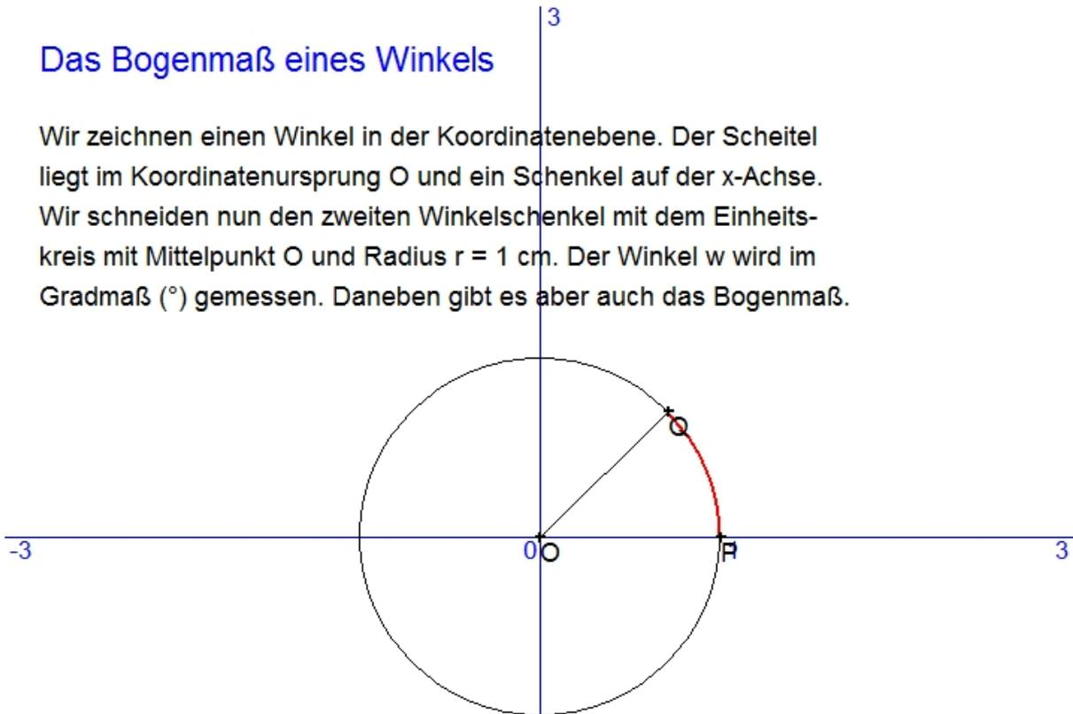
Einem vollen Drehwinkel von  $360^\circ$  entspricht der Umfang  $U = 2\pi$ .
