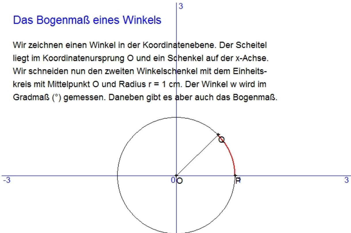
Einem vollen Drehwinkel von  $360^\circ$  entspricht der Umfang  $U = 2 \cdot \pi$ .
